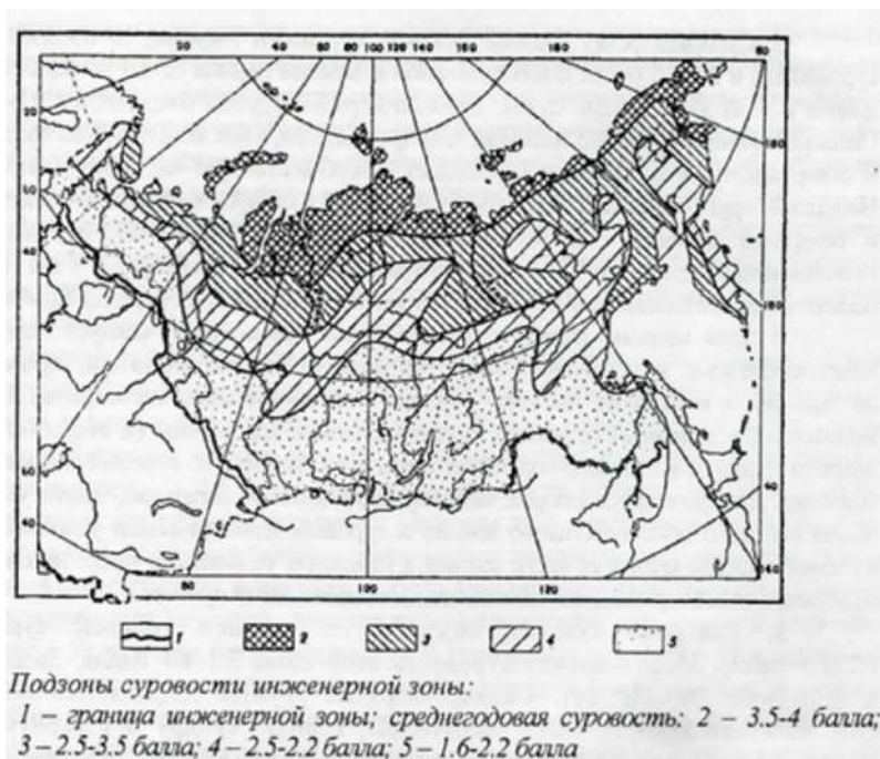
Рис. 3. Граница и подзоны инженерной зоны. Источник: Экономические и географические проблемы северной техники 1 .
